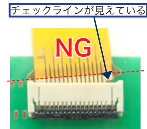
写真⑧：斜め挿入状態
